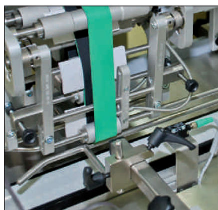
Friktionsanleger für das Zuführen des Hauptproduktes.
