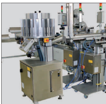
Geringer Personaleinsatz durch hohes Volumen der Beipackprodukte im Revolvermagazin.
