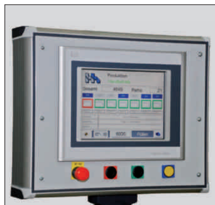
Von dem gut zugänglichen Bedienungspult erfolgt die Steuerung der Beipackmaschine 491 B.
