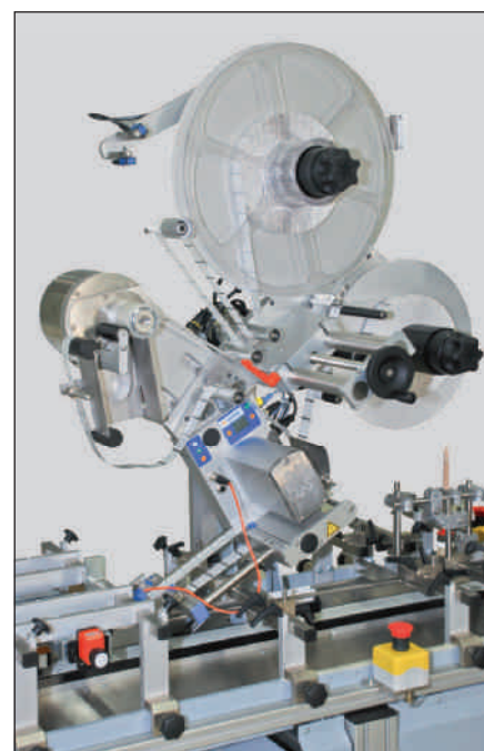
Der Etikettierer sorgt für einen zuverlässigen Verschluss des Produktes mit bis zu drei Etiketten.
