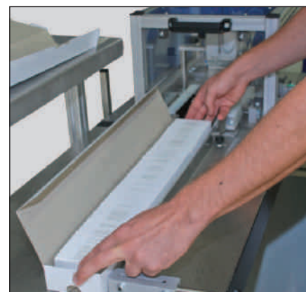
In der Kartonauslage wird der Karton automatisch gefüllt. Schließen und Austauschen des Kartons erfolgt manuell.
